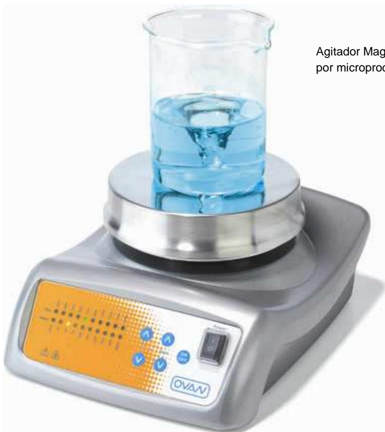
Agitador Magnético con Calefacción, controlado por microprocesador.
