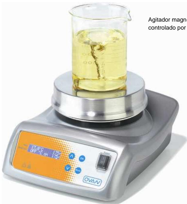
Agitador magnético digital con Calefacción, controlado por microprocesador.
