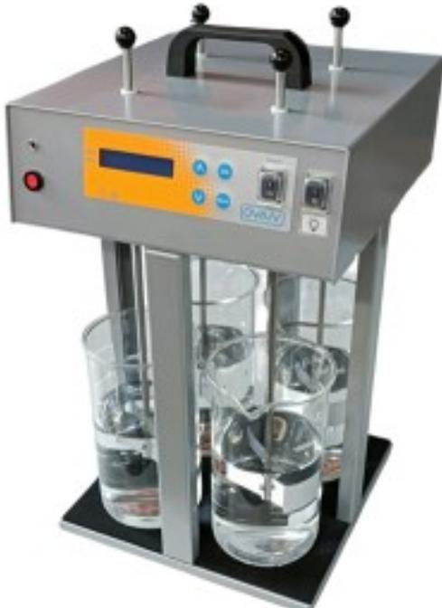
Floculador digital portátil, controlado por microprocesador.
